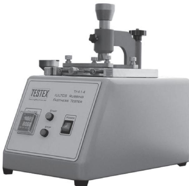
Máquina para realizar pruebas de frote en el cuero. Evalúa la cantidad de transferencia de color de la muestra a la almohadilla en seco o en condiciones húmedas.
