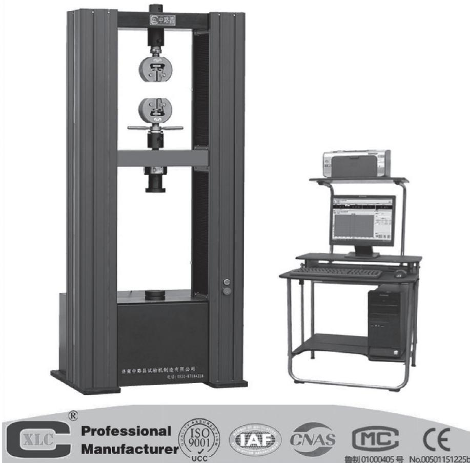
DIN, y otras normas internacionales. Aplicable para una amplia gama de materiales para tensión, compresión, flexión, corte y prueba de ciclo bajo. Adecuado para las pruebas de metal, caucho, plástico, primavera, textil y componentes. Es ampliamente utilizado en las industrias, investigación y desarrollo en institutos de ensayo y centros de formación, etc.
