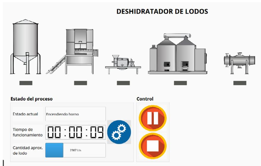
Figura 40. Interfaz de usuario para el proceso de deshidratado.
